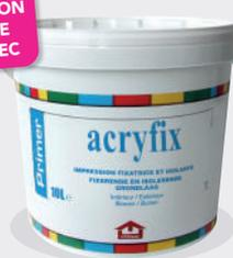
Impression fixatrice pour fonds farinants et isolante pour fonds alcalins (maçonneries neuves). Formulée à partir de résine acrylique en phase aqueuse. Destinée à être recouverte par une peinture décorative en finition.
