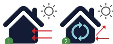
La peinture THEOTHERM® réfléchit plus le rayonnement solaire qu'une peinture traditionnelle. TSR (Total Solar Reflectance) : total = 88 % (DIN EN 410) mesuré par le CSTB (rapport EMI 15-26058427) UV = 8 %, Visible = 93 %, Infrarouge = 90 %.
